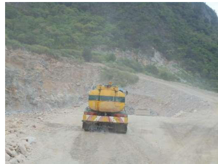
รูปที่ 2-21: การฉีดพรมน้ำบริเวณหน้าเหมือง
